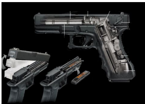
Esquema do interior de uma AEP e exemplo de colocação de bateria (Fonte: Tokyo Marui).
